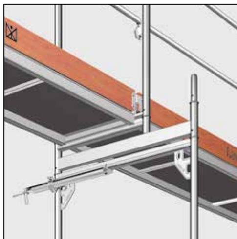
Fig. 116: Reduksjonsstykke ferdig montert
