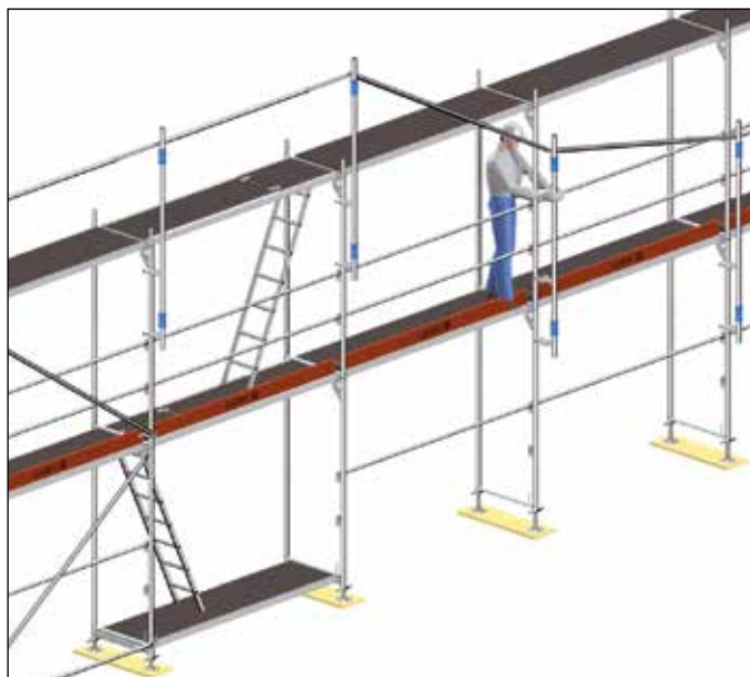
Fig. 26: Montøren flytter monteringsrekkverket en høyde opp
