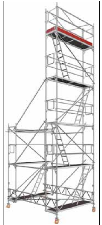
Fig. 142: To stillas kobles sammen med gitterdragere, stillasrør og faste og vribare koblinger.
