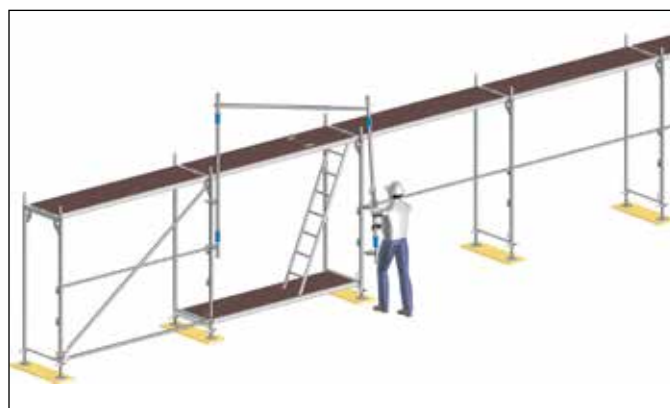
Fig. 25: Monteringsrekkeverk monteres her i oppgangsfaget
