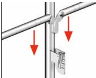
Fig. 39: Monter rekkverkernes endestykker i låsekassen
